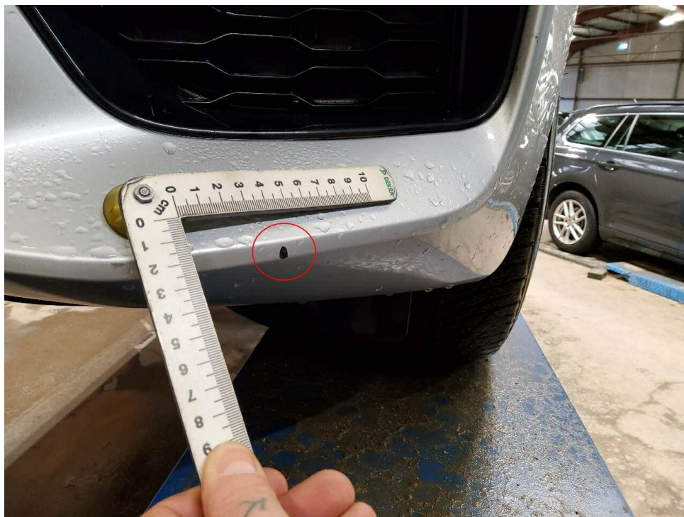
Bild 5 : Stoßfänger vorne Lackierung, zerkratzt
