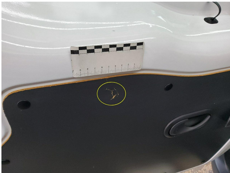
Bild 6 : Verkleidung Flügeltür links verschrammt
