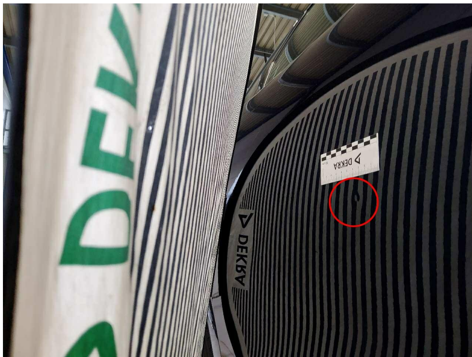
Bild 8 : Tür hinten rechts, eingedellt, Gebrauchsspur
