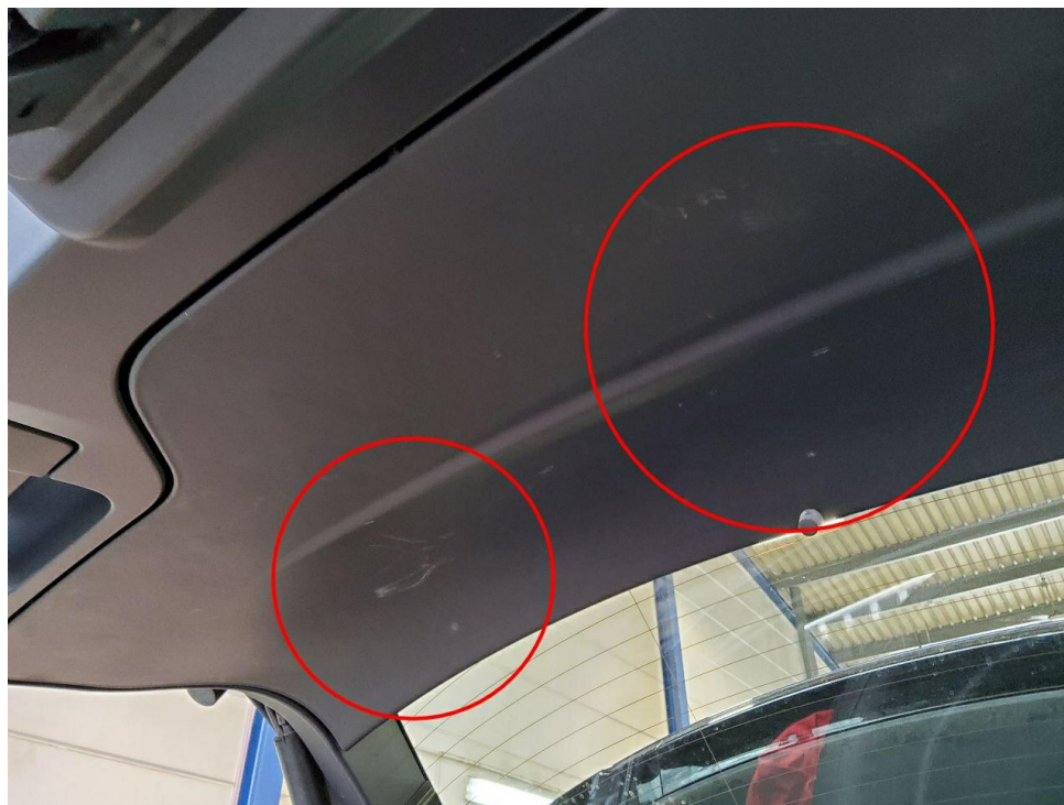
Bild 6 : Laderaum Innenverkleidung, teilweise verschrammt, Gebrauchsspur
