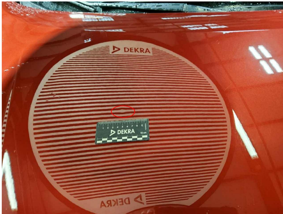
Bild 6 : Motorhaube, eingedellt, Gebrauchsspur
