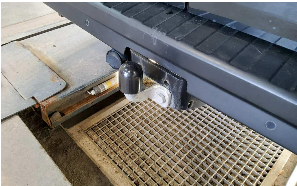
Bild 6 : Kugelkopf bei abnehmbarer Anhängerkupplung
