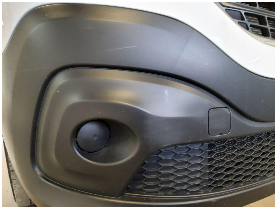
Bild 2 : Stoßfänger vorne, verschrammt, Gebrauchsspur
