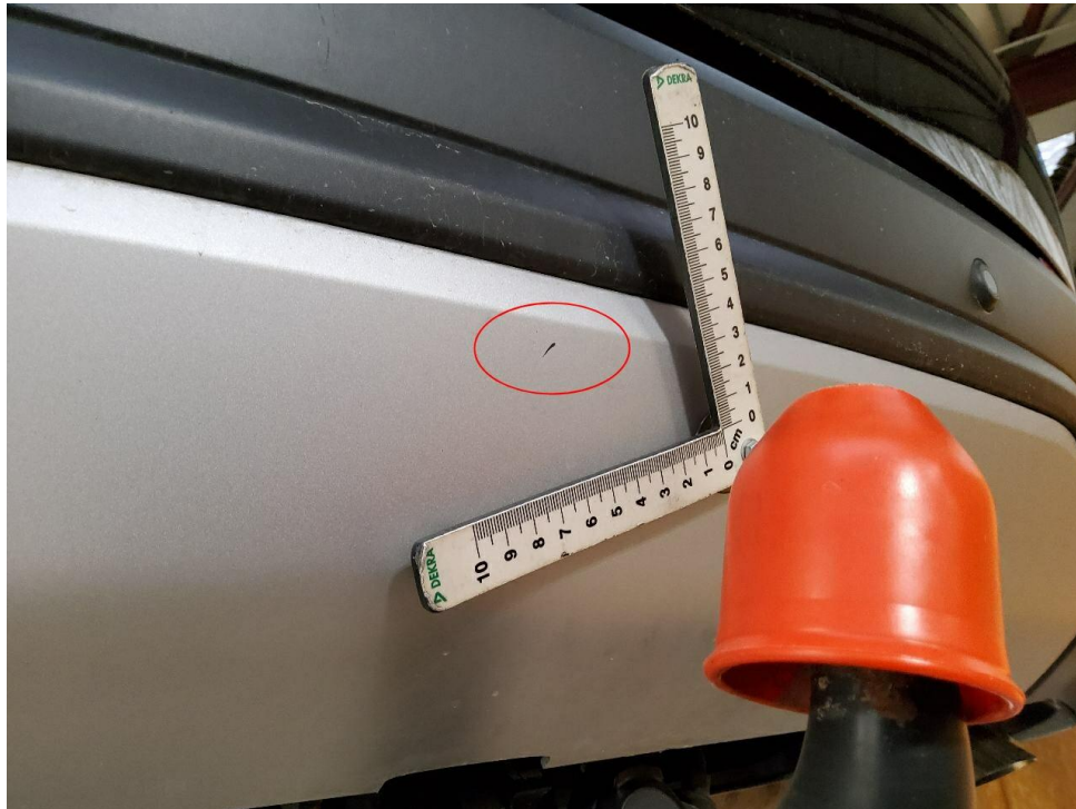
Bild 7 : Stoßfänger hinten Abdeckung unten, zerkratzt
