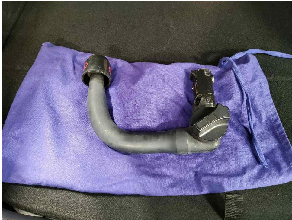
Bild 5 : Kugelkopf bei abnehmbarer Anhängerkupplung
