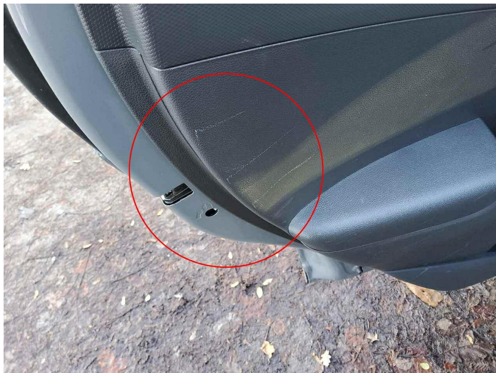
Bild 6 : Verkleidung Tür hinten links, verschrammt,
