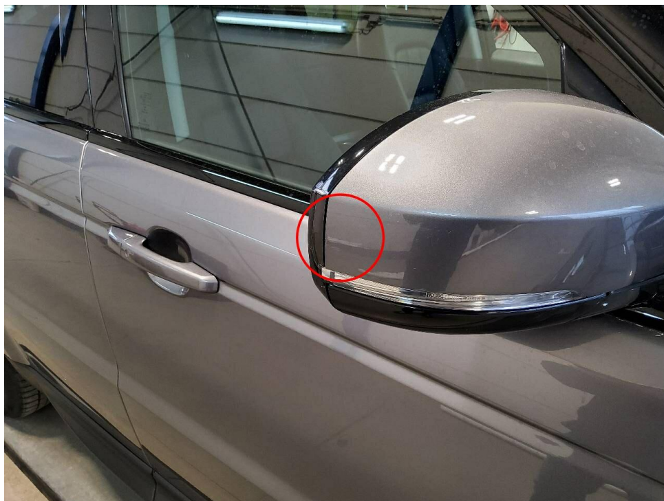
Bild 7 : Außenspiegel rechts, verschrammt, Gebrauchsspur
