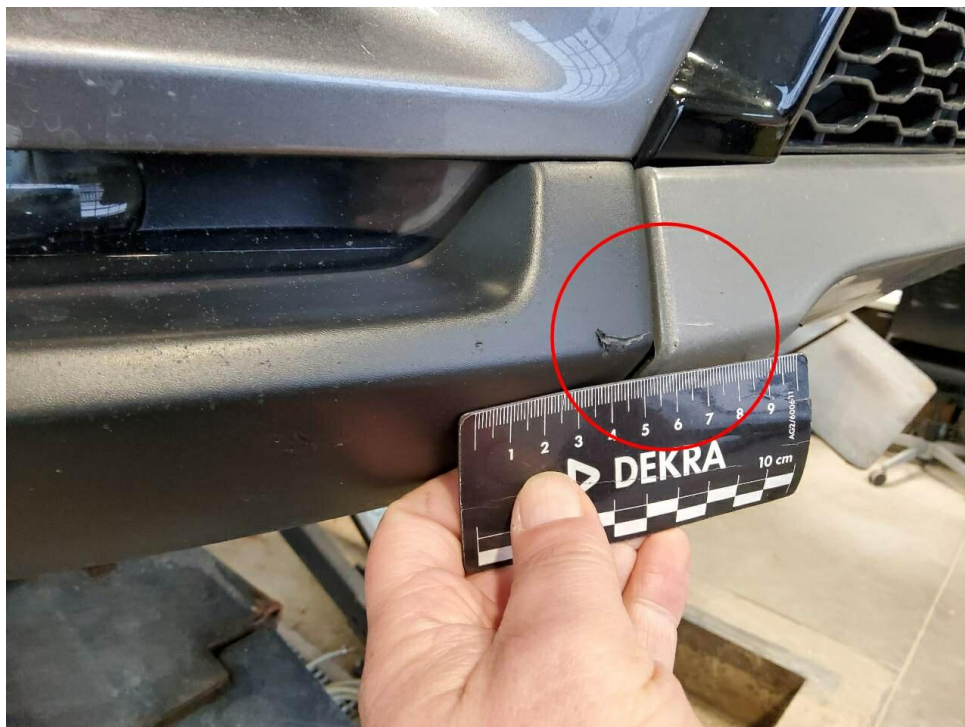
Bild 8 : Stoßfänger vorne, verschrammt, Gebrauchsspur
