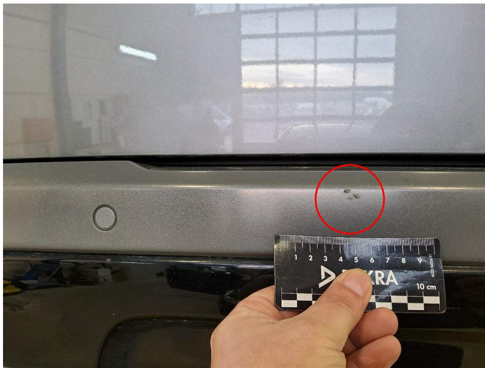
Bild 10 : Stoßfänger hinten, verschrammt, Gebrauchsspur
