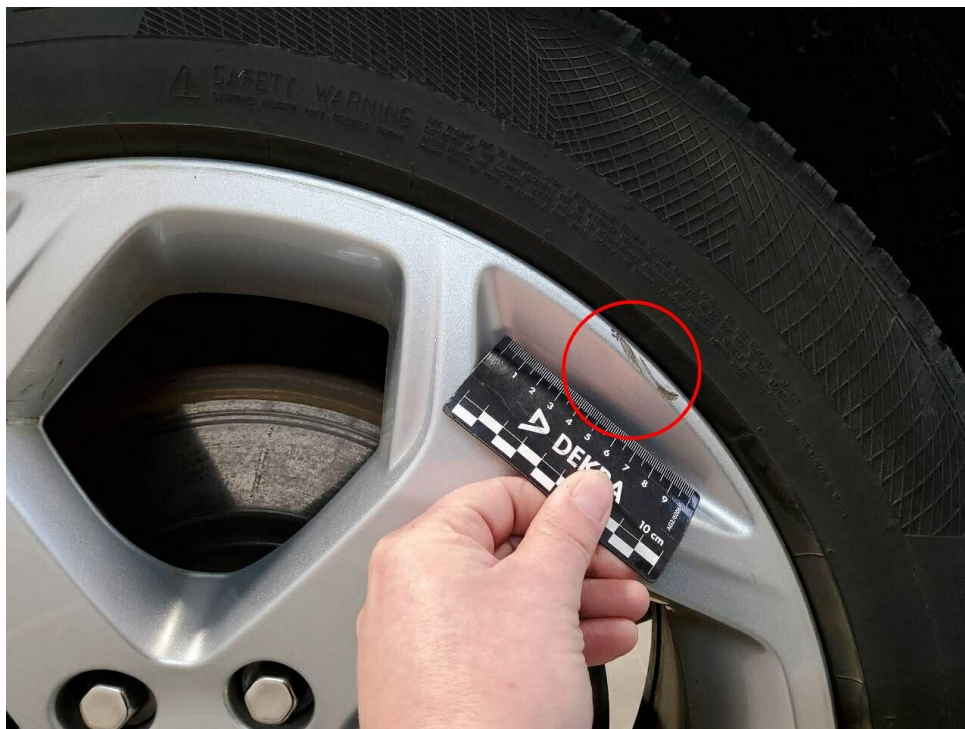
Bild 9 : Felge vorne rechts, verschrammt, Gebrauchsspur
