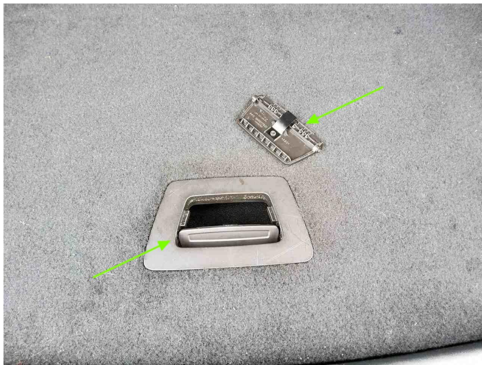
Bild 6 : Kofferraum, Griff Bodenbelag, ausgerissen
