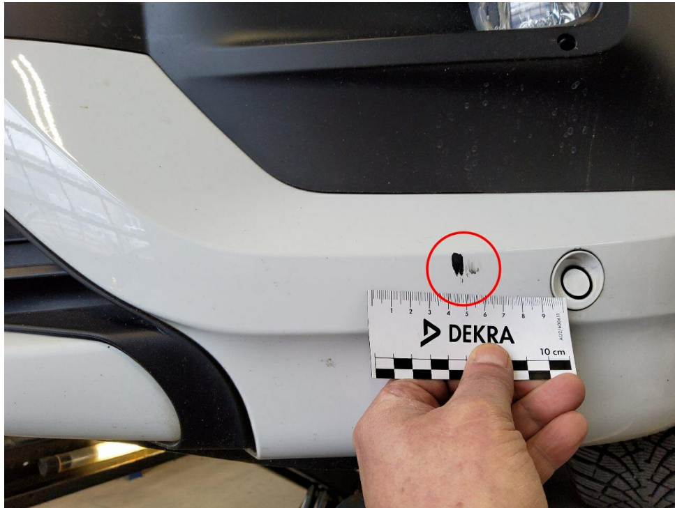
Bild 7 : Stoßfänger vorne, verschrammt, Gebrauchsspur
