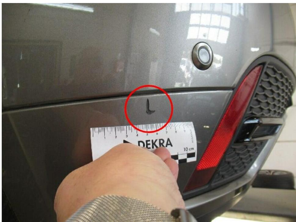
Bild 8 : Stoßfänger hinten, eingedellt und verschrammt. Gebrauchsspur
