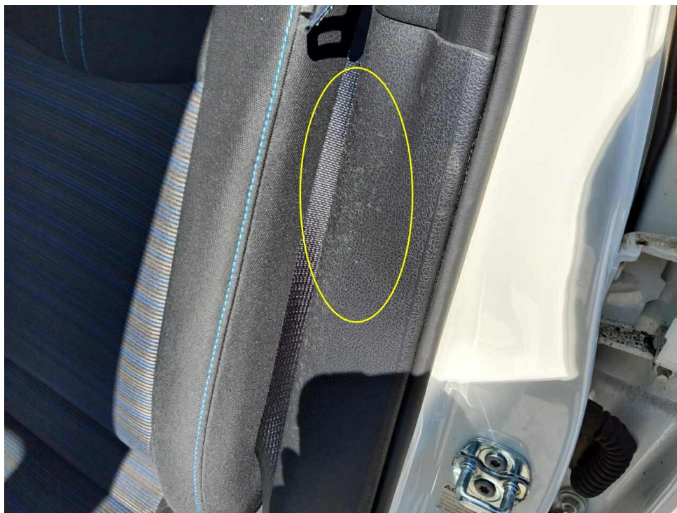
Bild 6 : Tür vorne links Einstieg, verschrammt, Gebrauchsspur
