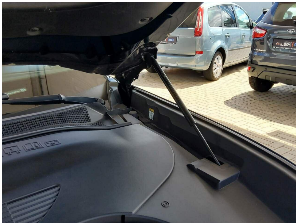
Bild 6 : Kofferraumhaubendämpfer vorne verschlissen
